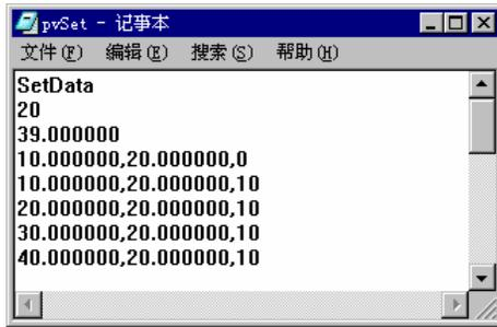
`pvIniPreCuve( "加热炉温控曲线", "c:\pvset.csv" );`
